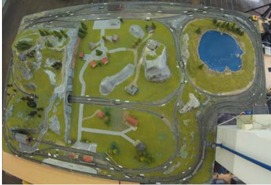
Abb. 3: Kameraaufsicht auf die Eisenbahnanlage im Versuch SPS zur Beobachtung der Zugfahrt.
